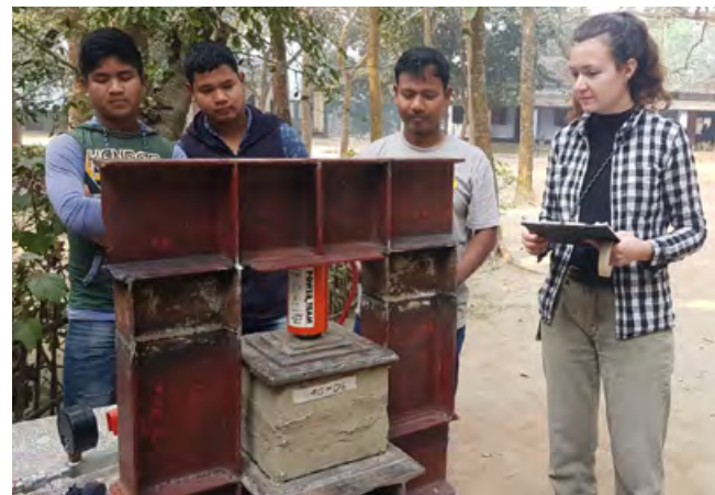
Christina Jötten bei der Druckfestigkeitsprüfung der Bausteine
